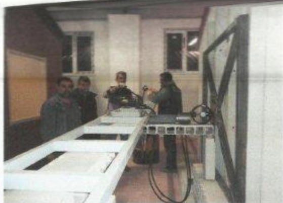
Resim 1c. Bina rüzgar yüklemesinden görünüş
